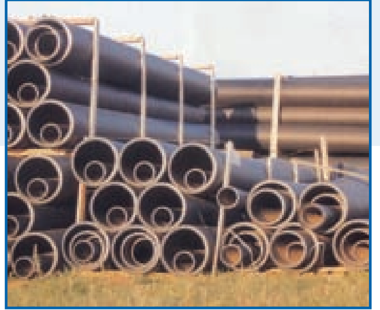
Resim 6.1.4- İç içe geçmiş boru.
