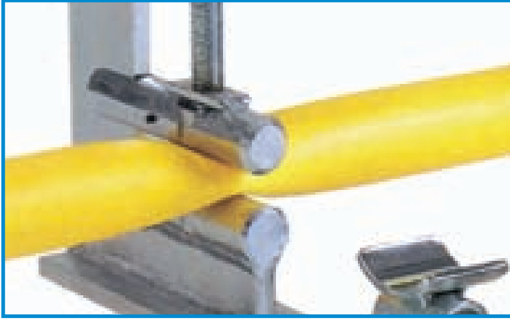
Resim 2.1.11 - Polietilen boruya uygulanan boğma işlemi
