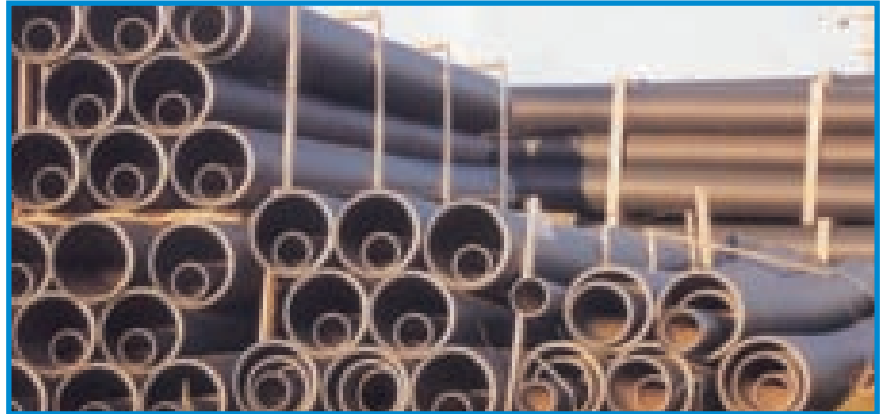
Resim 2.1.9 - İç içe geçmiş borular
