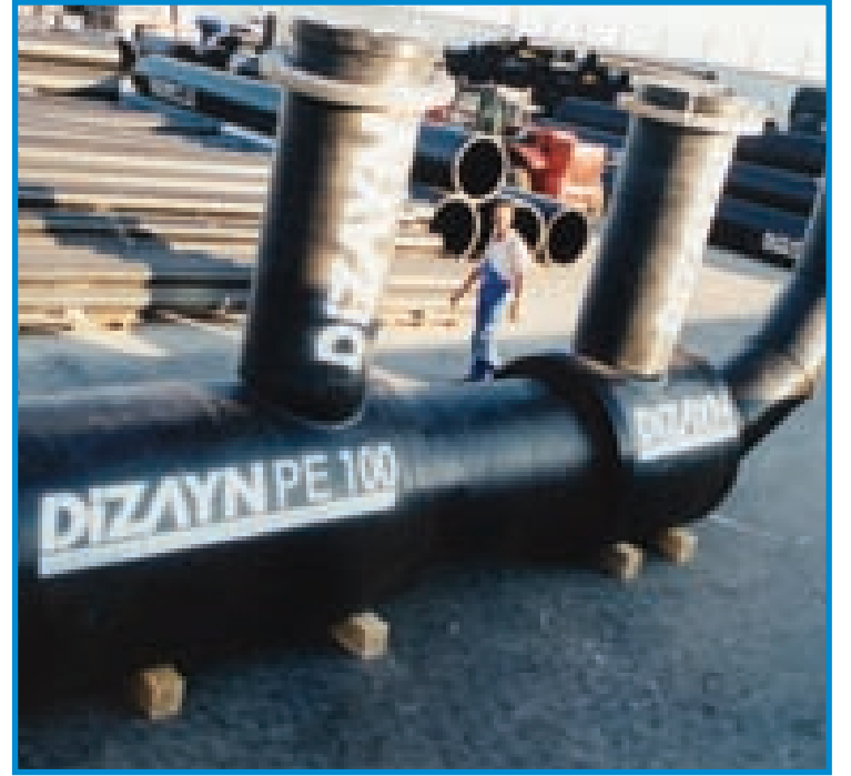
Resim 2.5.3. PE 100 özel üretimlerimizden "manifold"un görüntüsü.
